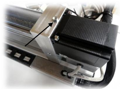
Abb. 31: Schmiernippel X-Achse
