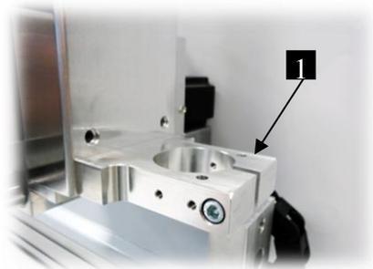
Abb.11: Werkzeugaufnahme 43H7
