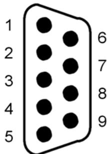
Abb. 15: Belegung Motorstecker Sub-D
