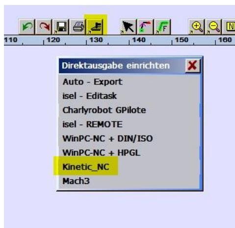
Klicken Sie mit der mittleren Maustaste auf den DirectMill-Button und wählen KinetiC-NC aus.
