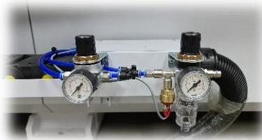
Abb. 10.6: Zwei Druckregelventile
