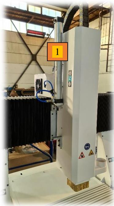
Abb.8.3: Z-Achse 400mm
