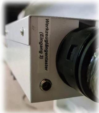
Abb. 10.4: Anschluss Werkzeuglängentaster
