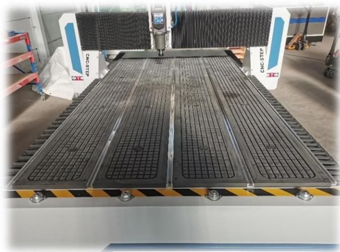
*Abb.12: Maschine mit Vakuumtisch und T-Schienen*
