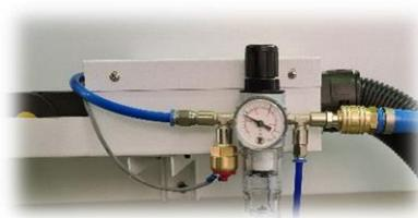
Abb. 8.4: Druckregelventil für Zylinder
