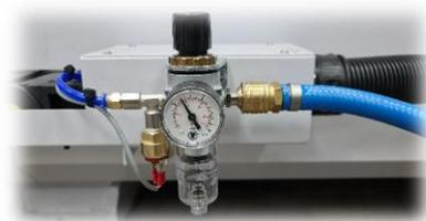
Abb. 10.5: Druckregelventil
