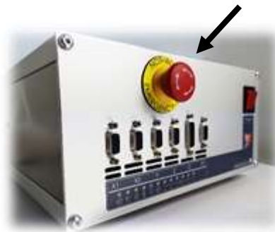
Abb. 3: Not-Aus-Taster an der Schrittmotorsteuerung
