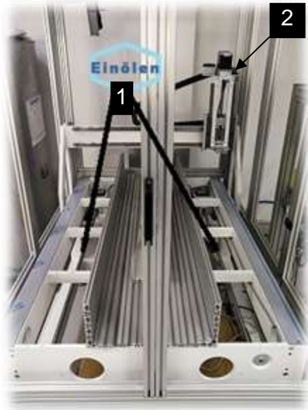
Abb. 28: Profilschienenführungen der X- und Z-Achse von oben
